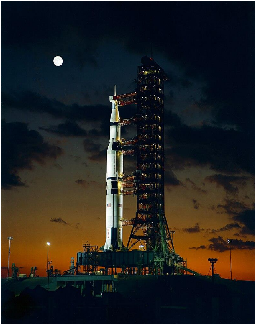
Fig.10. Saturn V, ici sur son pas de tir lors de la mission Apollo IV, est probablement la plus belle fusée jamais construite. Son accélération au décollage est très faible : 0,2g et atteint 3g en fin de combustion du 1 er étage (utilisation de la formule I), sa vitesse est alors de 1,5 km/s soit 5400 km/h et son altitude de 69 km ( respectivement formules II et III)
