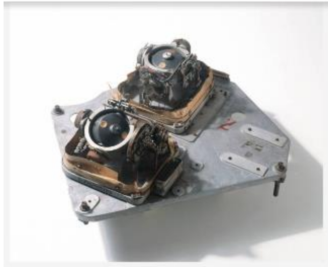
Fig7. L'un des secrets de la réussite de l'A4, les deux gyroscopes de stabilisation, ici sur leur plate-forme et dont les axes de rotation sont perpendiculaires.
