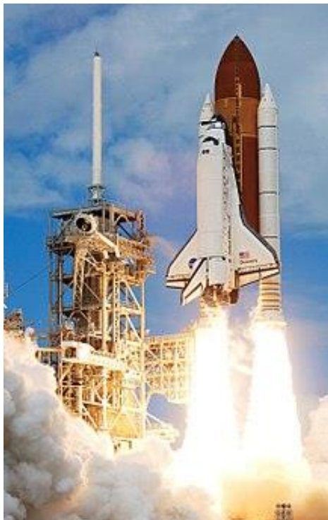
Fig.16. L'accélération est de 0,6g au décollage et atteint 2,5g lors de la séparation des propulseurs d'appoint. Vitesse et altitude sont respectivement de 5800 km/h et 70 km.
