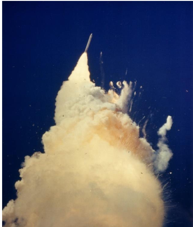
Fig.19. Le drame.28 janvier 1986. Il fait particulièrement froid depuis plusieurs jours à cap Canaveral. Les joints d'étanchéité des propulseurs d'appoint supportent mal les basses températures, un problème bien identifié par la Nasa. La veille du lancement, les responsables de la Nasa et les ingénieurs chargés de la construction et de la maintenance des propulseurs d'appoint, s'entretiennent. Certains mettent en en garde. Le lancement est maintenu. Ce 28 janvier 1986, 73s après le décollage, Challenger explose tuant les 7 membres d'équipage. En utilisant la formule III, on montre que l'altitude était d'environ 20 km lorsque Challenger explosa
