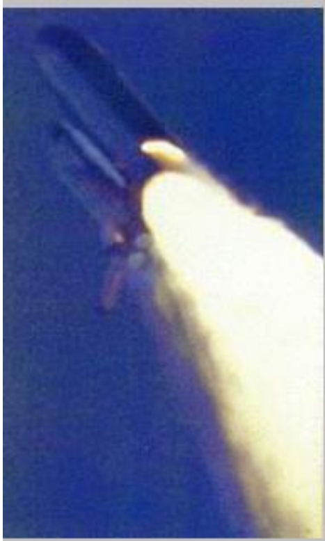
Fig.19. Le drame.28 janvier 1986. Il fait particulièrement froid depuis plusieurs jours à cap Canaveral. Les joints d'étanchéité des propulseurs d'appoint supportent mal les basses températures, un problème bien identifié par la Nasa. La veille du lancement, les responsables de la Nasa et les ingénieurs chargés de la construction et de la maintenance des propulseurs d'appoint, s'entretiennent. Certains mettent en en garde. Le lancement est maintenu. Ce 28 janvier 1986, 73s après le décollage, Challenger explose tuant les 7 membres d'équipage. En utilisant la formule III, on montre que l'altitude était d'environ 20 km lorsque Challenger explosa
