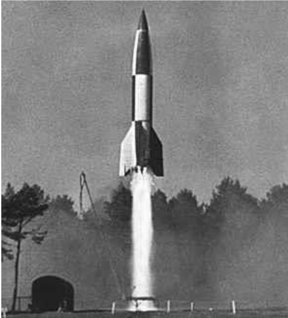
Fig.2. 3 octobre 1942, 1 er lancement réussi de la fusée A4. L'accélération est de 1g lors du décollage et de 4g en fin de combustion (utilisation de la formule I), la vitesse est alors de 1,25 km/s soit 4500 km/h (utilisation de la formule II) et son altitude d'environ 30km. Bien que sans propulsion, l'A4 poursuit sa course pour culminer à 90km avant d'entamer sa descente. On remarquera les damiers noirs et blancs qui permettent de vérifier la stabilité autour de son axe longitudinal.
