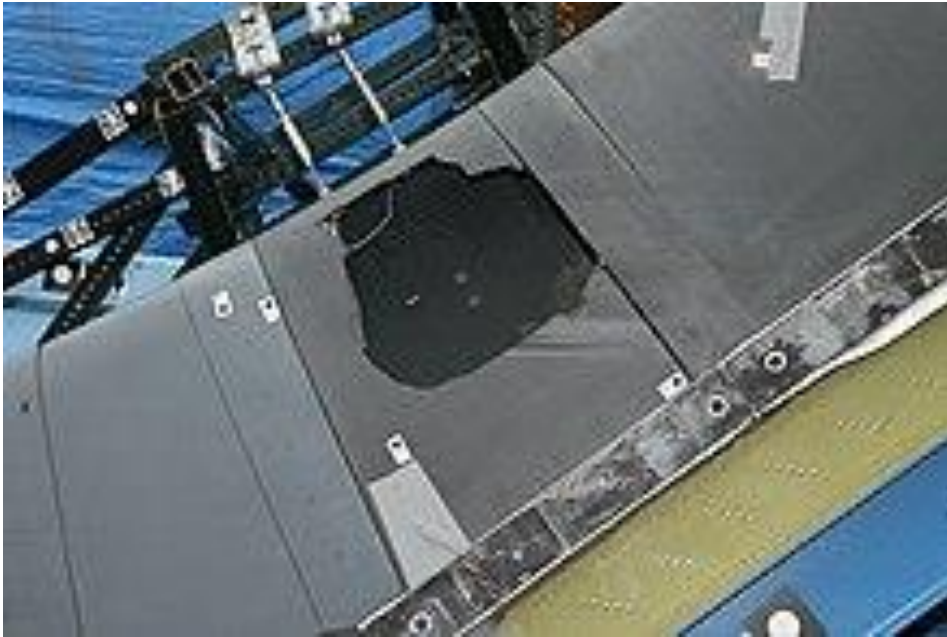
Fig.22. Résultat d'un test en laboratoire simulant l'impact d'un morceau de mousse isolante sur une tuile de la protection thermique
