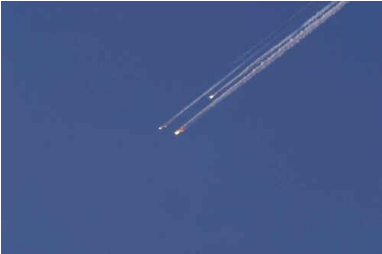
Fig.20. Lors du lancement le 16 janvier 2003, un fragment de mousse isolante se détache du réservoir ventral et endommage le bouclier thermique du bord d'attaque de l'aile gauche de l'orbiteur Columbia se désintègrera le 1 er février 2023 lors de sa rentrée dans l'atmosphère, tuant les 7 membres d'équipage.
