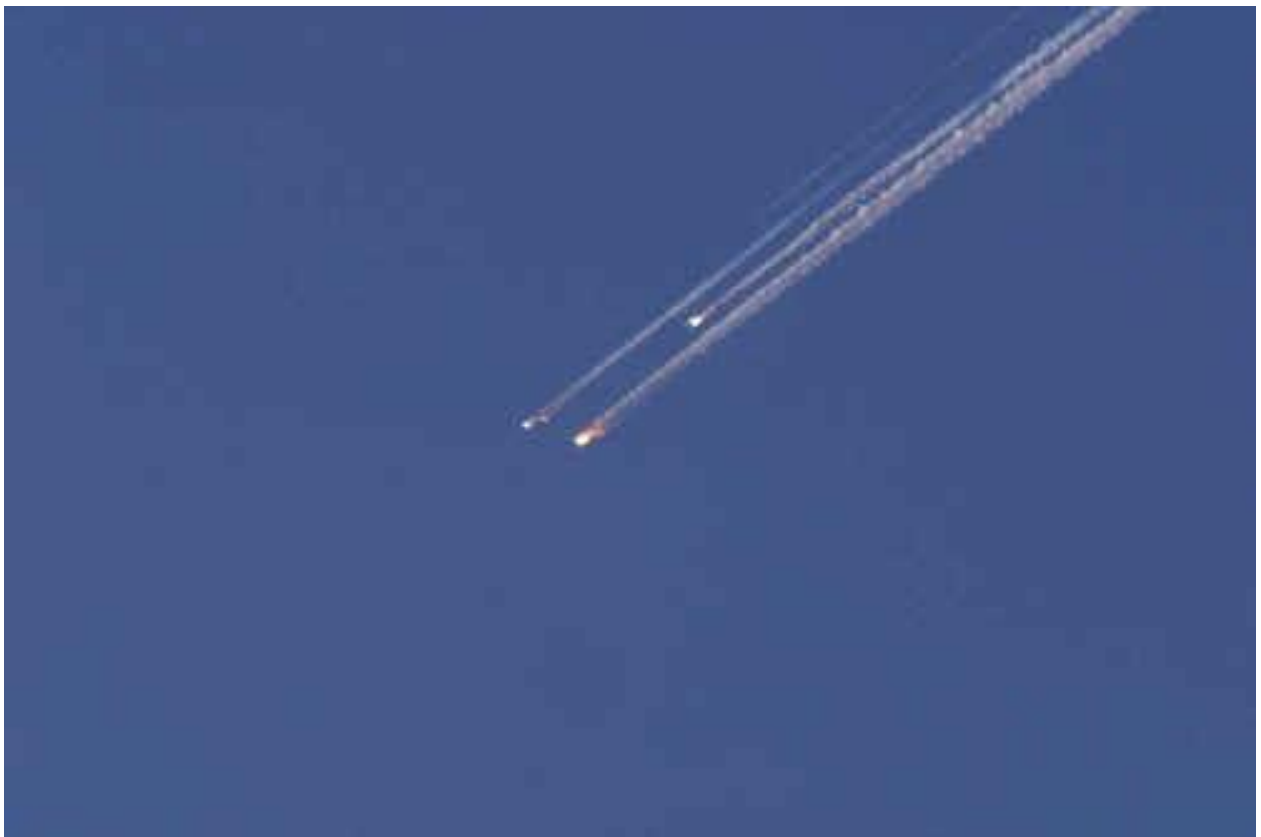
Fig.21. Lors du lancement le 16 janvier 2003, un fragment de mousse isolante se détache du réservoir ventral et endommage le bouclier thermique du bord d'attaque de l'aile gauche de l'orbiteur. Columbia se désintégrera le 1 er février 2003 lors de sa rentrée dans l'atmosphère, tuant les 7 membres d'équipage.
