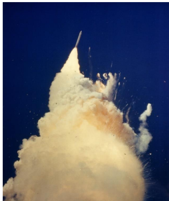
Fig.20. Le drame.28 janvier 1986. Il fait particulièrement froid depuis plusieurs jours à cap Canaveral. Les joints d'étanchéité des propulseurs d'appoint supportent mal les basses températures, un problème bien identifié par la Nasa. La veille du lancement, les responsables de la Nasa et les ingénieurs de la société chargée de la construction et de la maintenance des propulseurs d'appoint, s'entretiennent. Certains d'entre-eux alertent. Le lancement est maintenu. Ce 28 janvier 1986, 73s après le décollage, Challenger explose, tuant les 7 membres d'équipage.
