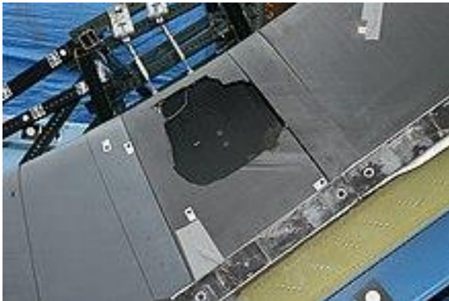
Fig.23. Résultat d'un test en laboratoire simulant l'impact d'un morceau de mousse isolante sur une tuile de la protection thermique
