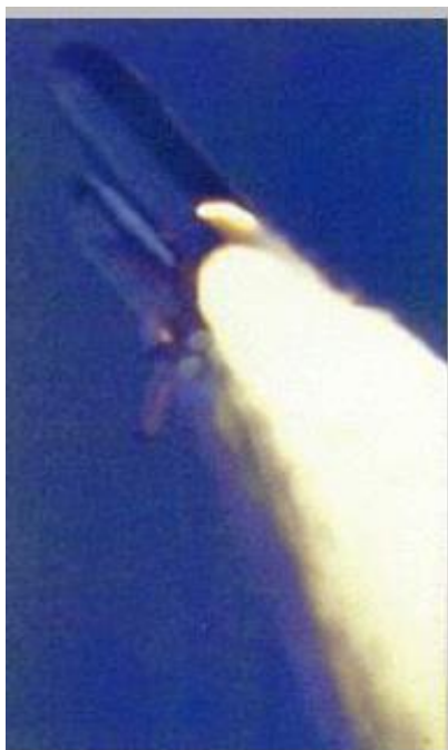
Fig.20. Le drame.28 janvier 1986. Il fait particulièrement froid depuis plusieurs jours à cap Canaveral. Les joints d'étanchéité des propulseurs d'appoint supportent mal les basses températures, un problème bien identifié par la Nasa. La veille du lancement, les responsables de la Nasa et les ingénieurs de la société chargée de la construction et de la maintenance des propulseurs d'appoint, s'entretiennent. Certains d'entre-eux alertent. Le lancement est maintenu. Ce 28 janvier 1986, 73s après le décollage, Challenger explose, tuant les 7 membres d'équipage.
