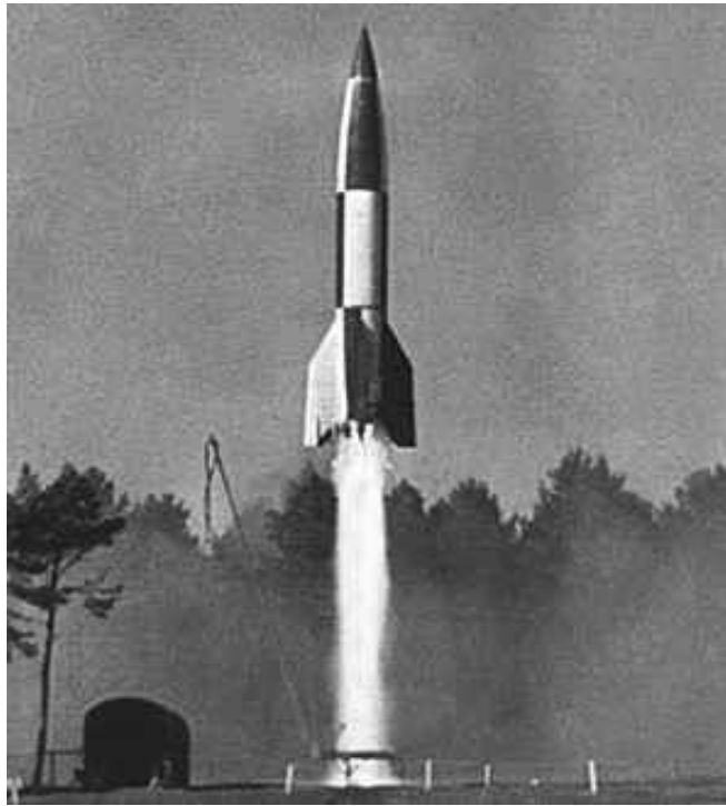
Fig.7. 3 octobre 1942, 1 er lancement réussi de la fusée A4. On remarquera les damiers noirs et blancs qui permettent de vérifier la stabilité de l'engin autour de son axe longitudinal.
