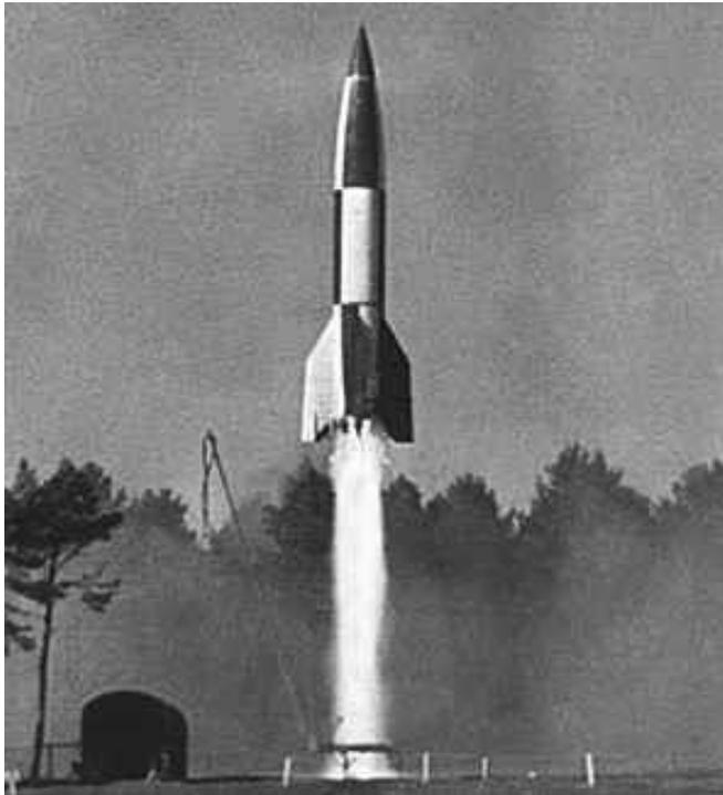
Fig.7. 3 octobre 1942, 1<sup>er</sup> lancement réussi de la fusée A4. On remarquera les damiers noirs et blancs qui permettent de vérifier la stabilité de l'engin autour de son axe longitudinal.
