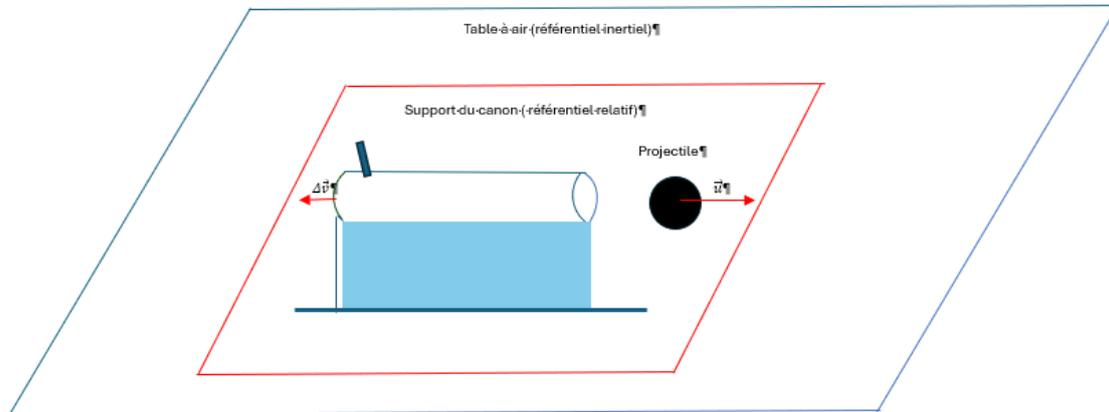
Fig.2. Indication du sens des vitesses après l'explosion.
