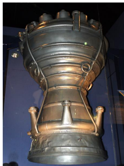
La turbopompe et le moteur fusée de l'A4. Lorsqu'on évoque Peenemünde on pense aux savants : von Braun ; Thiel, Riedel, Steinhoff, Gröttrup, mais on oublie les dizaines d'ouvriers hautement qualifiés, tourneurs, fraiseurs, ajusteurs, soudeurs sans qui rien n'aurait été possible.
