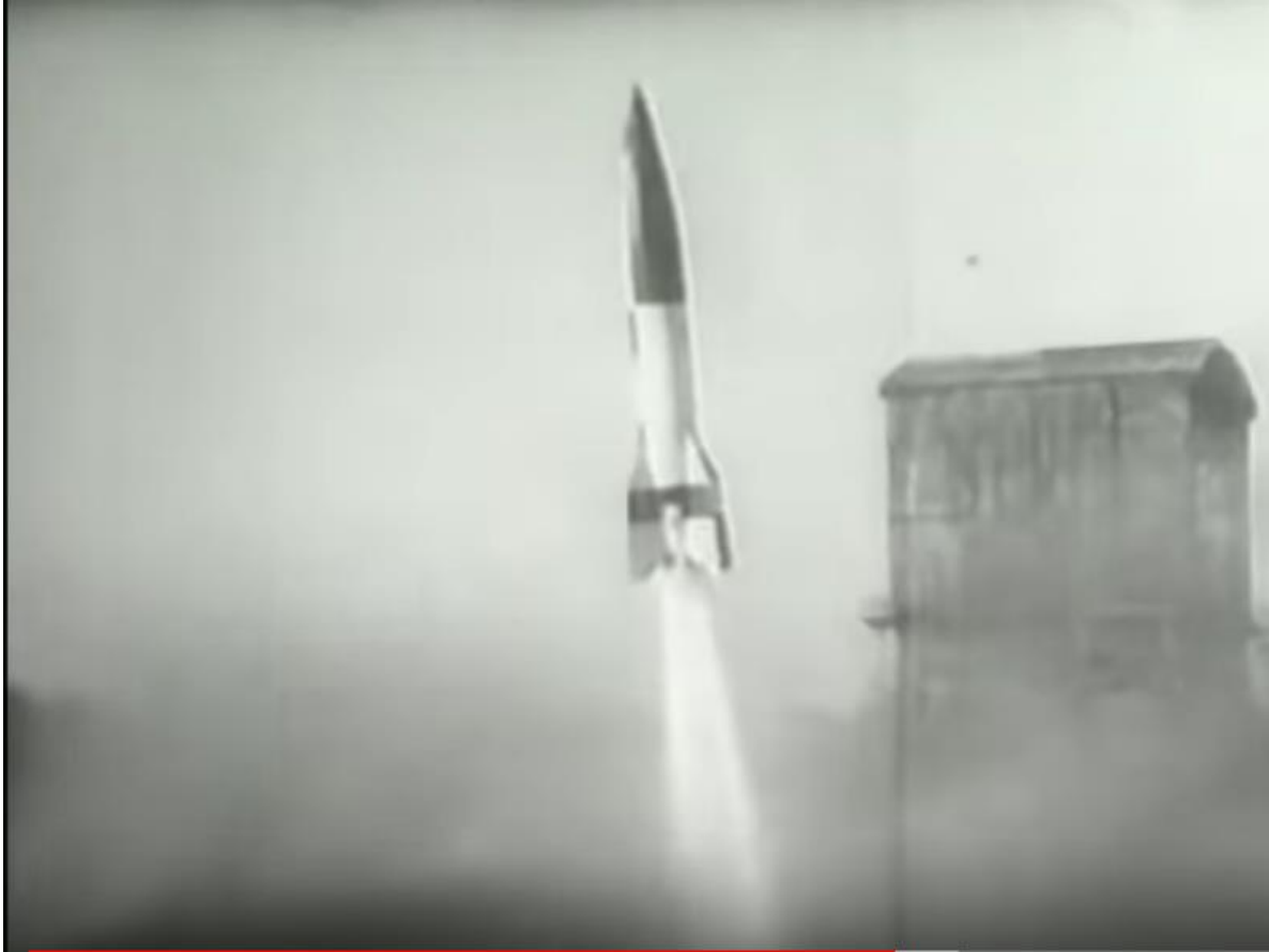
Décollage d'une fusée A4, on distingue nettement sur cette image que la fusée s'écarte vers la gauche suite à un problème de stabilisation. Elle s'écrasera quelques kilomètres plus loin (film d'époque).
