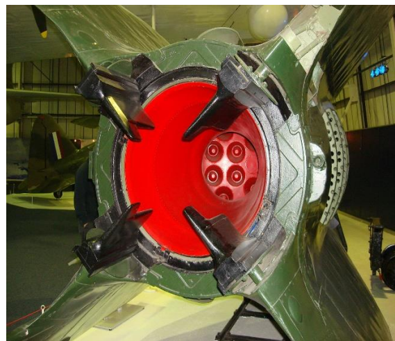
Les déflecteurs du jet gazeux ( film d'époque à gauche ; musée de la RAF à Londres à droite). Sur la photo de droite on distingue les injecteurs de la chambre de combustion.
