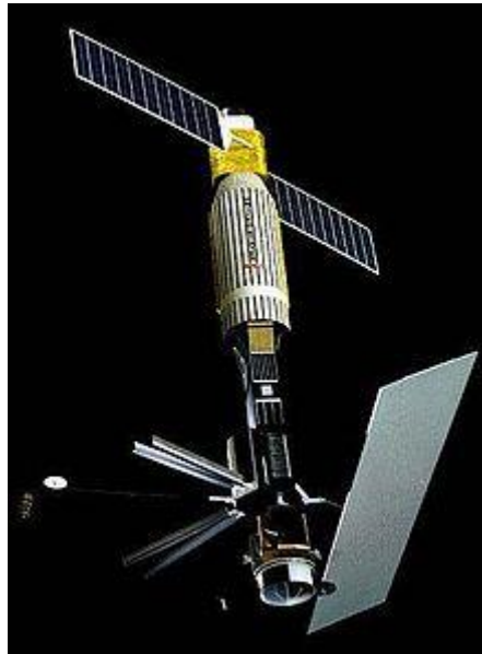
Le satellite Seasat. Son orbite quasi circulaire est héliosynchrone. L'inclinaison sur le plan équatorial est de 108°, son altitude est de 800 km.
